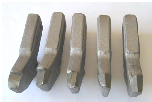
Рис. 1. Общий вид радиальных резцов и виды их поломок
