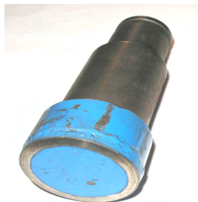
Рис. 4. Общий вид вращающегося резца со вставкой в виде сплошного кольцевого элемента (гладкий резец) [2]
