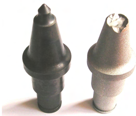
Рис. 3. Виды поломок тангенти-альных поворотных резцов: а – фирмы «Техпоставка»; б – фирмы «Кеннаметалл» (США)
