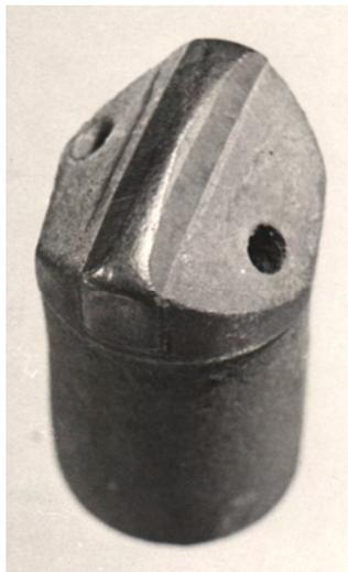
Рис. 4. Внешний вид рабочей части изношенной долотчатой буровой коронки
