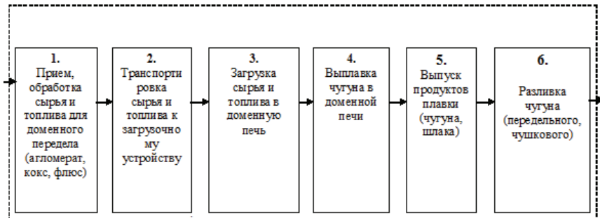
Рис.2. Структурная схема доменного производства металлургического предприятия
