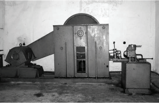
Рис.3. Испытательный стенд для моделирования условий торможения железнодорожных колес
