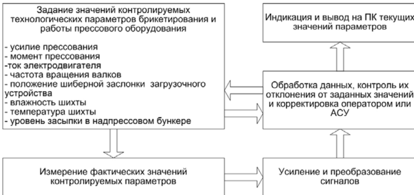
Рис. 1. Структурная схема измерения параметров процесса брикетирования
