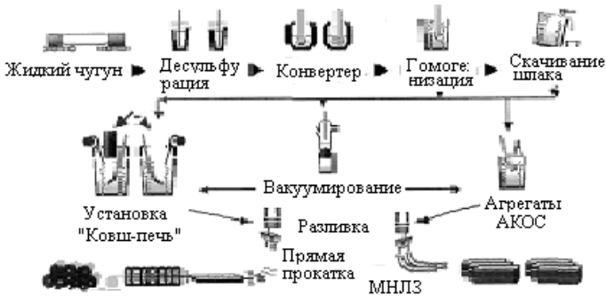
Рис. 1. Современная схема производства качественной стали.
