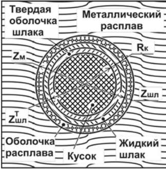
Рис. 2. Расчетная область к периоду образования оболочки расплава на шлаковой оболочке на поверхности тугоплавкого куска.
