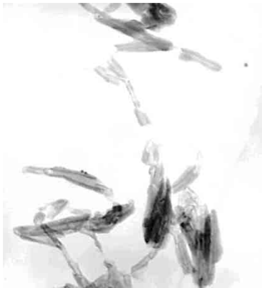
Рис. 5. Фотография электронного изображения алюмосиликатных нанотрубок, наполненных полимером
