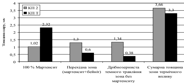
Рис.5. Порівняльний аналіз структурних складових сталей КП2 та КПТ в зоні термічного впливу.
