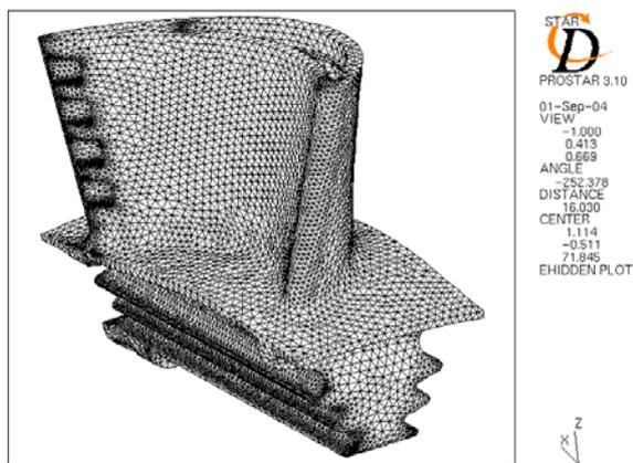
**Рис. 1.** Общий вид и расчетная сетка охлаждаемой лопатки ГТД.
