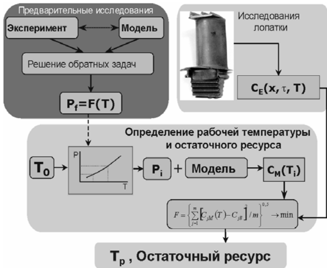
Рис. 2. Схема метода для определения остаточного ресурса и средней рабочей температуры защитных покрытий лопаток газовых турбин.
