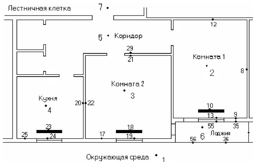
Рис. 1. План исследуемой двухкомнатной квартиры. Номерами обозначены точки, в которых проводились измерения температур и тепловых потоков.
