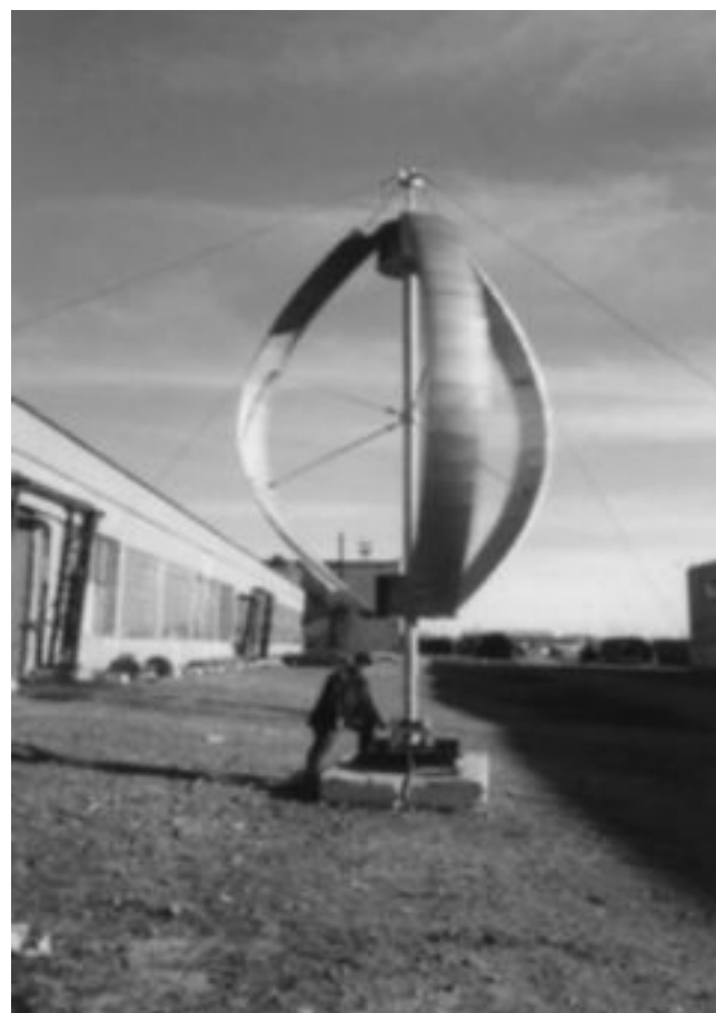
Рис. 2. Ветроагрегат Дарье системы тропоскино.
