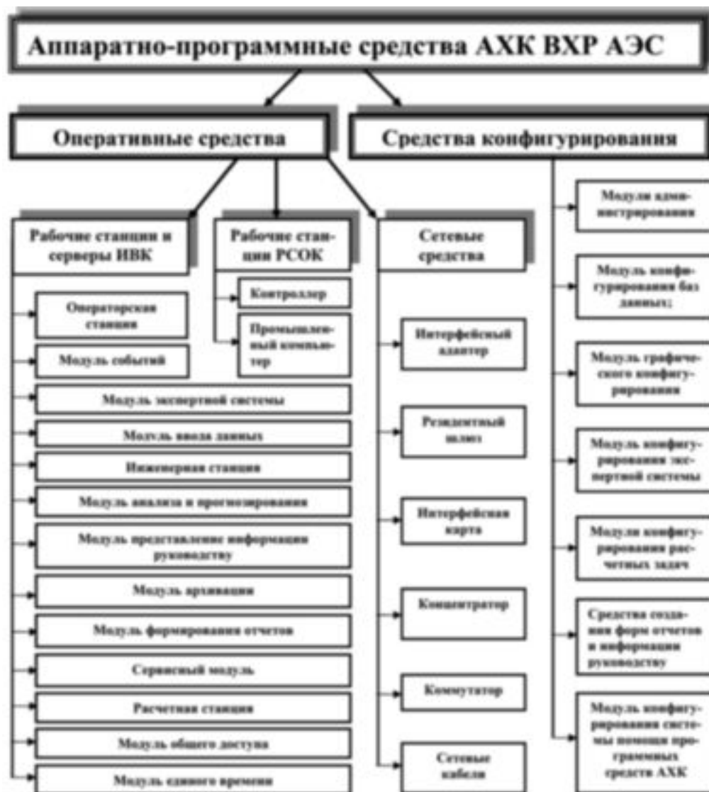
Рис. 1. Состав аппаратно-программных средств системы АХК ВХР АЭС.
