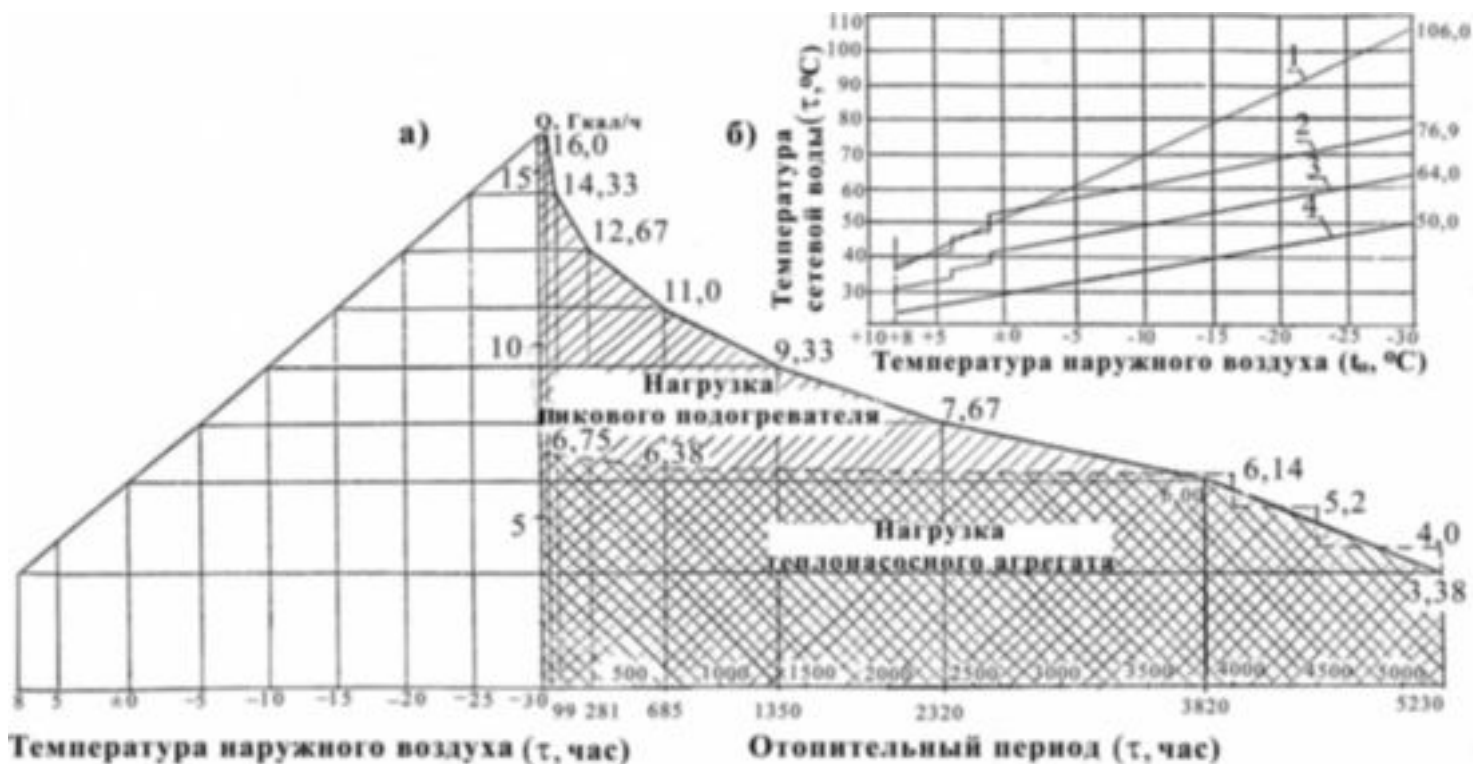
Рис. 4. Годовой график отопительной нагрузки (а) и график температур сетевой воды (б): \Sigma Q_c \approx 40600 Гкал; Q_{min} \approx 30800 Гкал.
