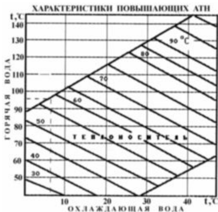
Рис. 2. Характеристики повышающего термотрансформатора на растворе LiBr–H 2 O.
