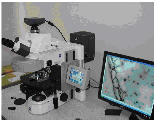
**Рис. 2.** Микроскоп просвечивающего и отбивающего света Axio Imager Carl Zeiss.
