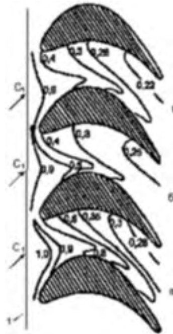
Рис. 3.1. Интенсивность заградительного охлаждения на торцевой поверхности межлопаточного канала активной решетки: а, б, в – Re и m соответственно равны 4,8 \cdot 10^5 и 1,5 ; 2,9 \cdot 10^5 и 0,69 ; 3,8 \cdot 10^5 и 0,65 ; 1 – линия среза сопла щели.
