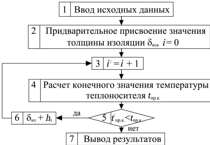
**Рис. 3. Блок-схема расчета толщины изоляции при заданных параметрах теплоносителя на выходе из трубопровода.**
