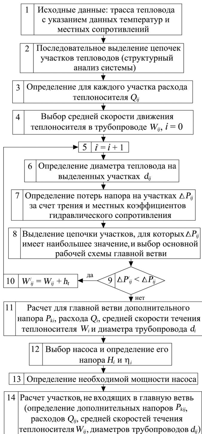
**Рис. 4. Блок-схема теплогидравлического расчета трубопроводов системы теплоснабжения.**
