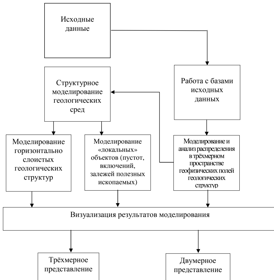
Рис. 1 – Блок-схема создания математических моделей геологических структур
