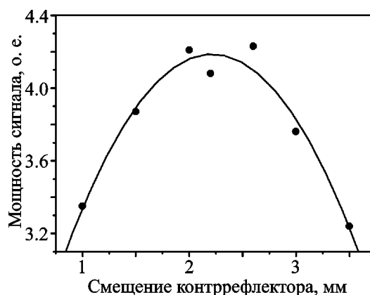
Рис. 3. Зависимость мощности принятого сигнала от положения контррефлектора. Сплошной линией показана аппроксимация экспериментальных данных параболой, точки – экспериментальные данные
