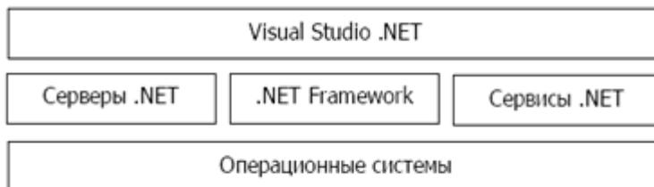
Рисунок 2 – Схема технологии .NET Framework
