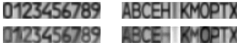
Рисунок 3 – Усредненные шаблоны символов автомобильных номеров (в верхнем ряду) и оптимизированные шаблоны символов (в нижнем ряду) для цифр и букв
