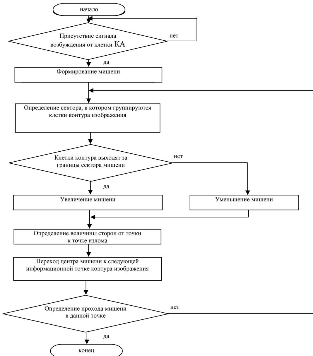
Рисунок 9 – Алгоритм функционирования клеток КАм
