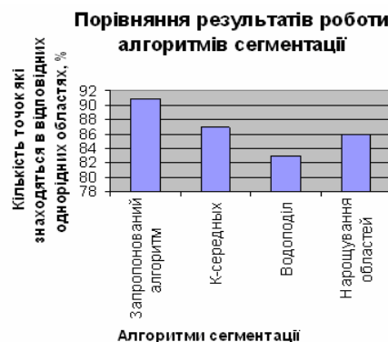
Рисунок 4 – Порівняння результатів роботи алгоритмів сегментації
