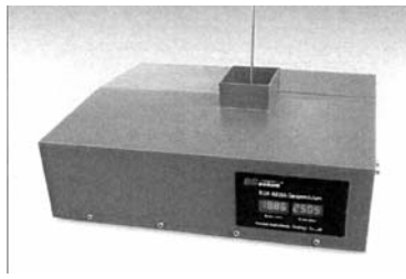
Рис. 3. Модель 6850. Электронное устройство обратного отвеса
