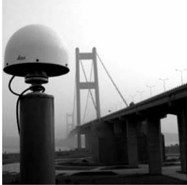
Рис. 8. ГНСС приемник GMX 902 GG на пункте опорной сети для мониторинга деформаций подвесного моста через реку Янцзы в Китае
