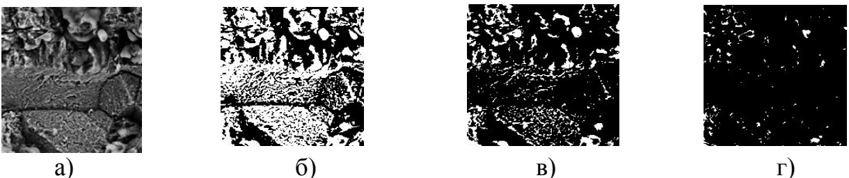
Рисунок 1 – Обробка вхідного зображення (а) глобальним пороговим методом при значенні порогу L_T = 0,3 (б), L_T = 0,5 (в), L_T = 0,7 (г)
