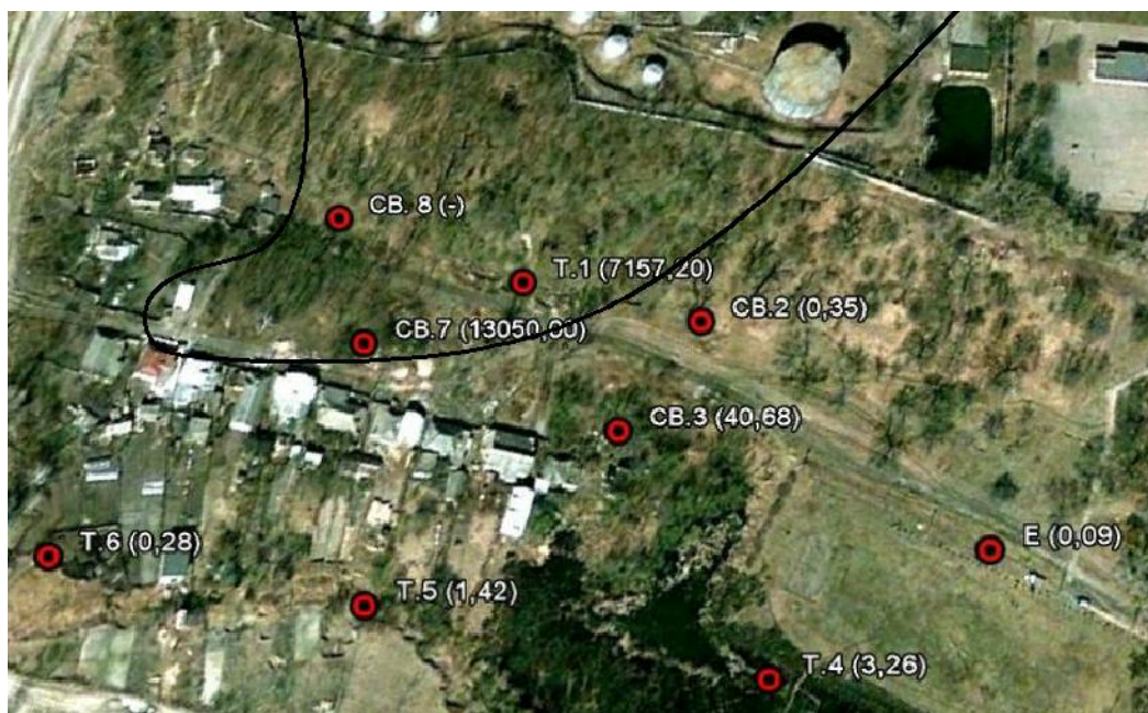
Рис. 3. Розміщення точок відбору проб в експерименті (в дужках представлена концентрація СН, мг/дм 3 , лінією виділено територію ареолу поширення СН за [2, 3])
