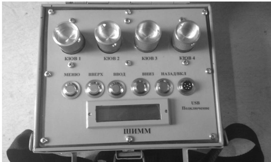
Рис. 2. Шахтный измеритель массопереноса метана ШИММ (ДС-03)
