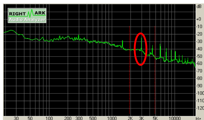
Рисунок 1 – Спектр звукового сигнала компрессора ГТН главного дизеля 6L80MCE
