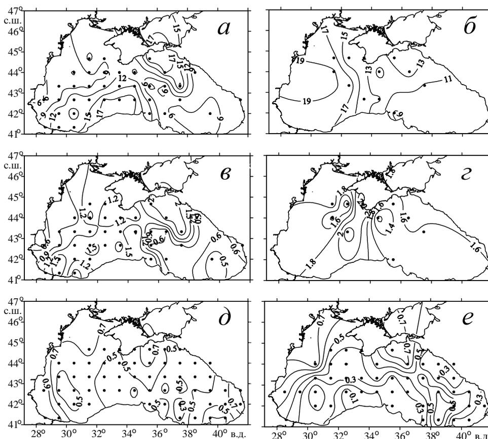
**Р и с. 3.** Распределение концентраций  $S_{\text{ВОВ}}$ , мкМ (а, б),  $N_{\text{ВОВ}}$ , мкМ (в, в) и  $C_{\text{ХЛ}}$ , мг/м<sup>3</sup> (д, е) в поверхностном слое (а, в, д) и в слое фотосинтеза (б, в, е) в осенний период (точки – центры квадратов, по данным для которых проводилось осреднение)
