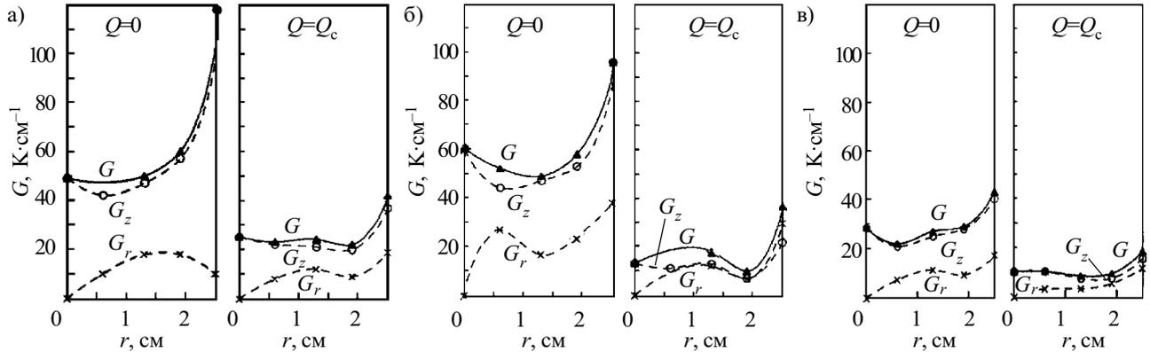
Рис. 6. Радиальное распределение составляющих  $G_z$  и  $G_r$ , а также модуля  $G$  температурного градиента при боковом нагреве тигля (вариант 23):
