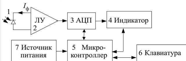
Рис. 1. Функциональная блок-схема прибора ( $I_\phi$  — ток фотодиода)
