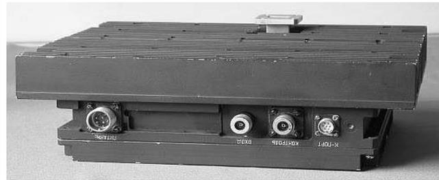
Рис. 1. Общий вид блока усилителя мощности К<sub>u</sub>-диапазона
