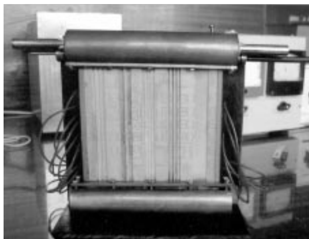
Рис. 6. Вид рабочего участка с испарительными каналами прямоугольного сечения
