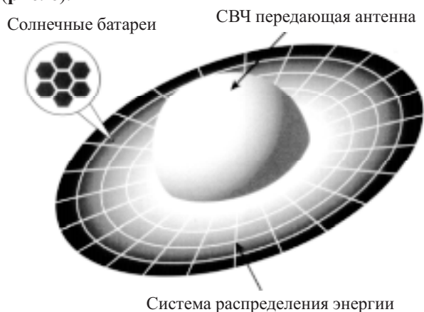
Рис. 6. Схема СКЭС с вращением конструкции (Япония)
