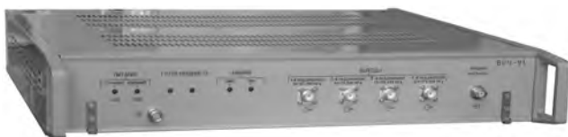
Рис. 4. Внешний вид базовой конструкции возбуждателя-синтезатора частот диапазона 30...180 МГц
