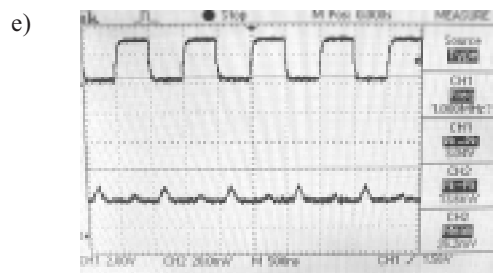
Рис. 10. Осциллограммы сигнала на выходе фотоприемника при различных фазовых сдвигах между каналами 0 и 1 генератора AD9959: a — 0°; б — 240°; в — 120°; г — 180°; д — 170°; е — 190°
