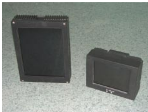
Рис. 4. ЖК-мониторы в портретном (10,4") и альбомном (6,5") вариантах исполнения
