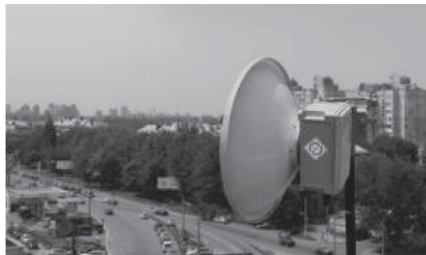
Радиорелейная станция диапазона 40,5—43,5 ГГц
