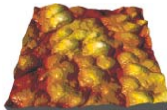
Рис. 1. АСМ-изображение поверхности структуры p-Cu_xS/n-ZnS/n-CdSe/Mo ( 10 \times 10 \times 1 мкм)
