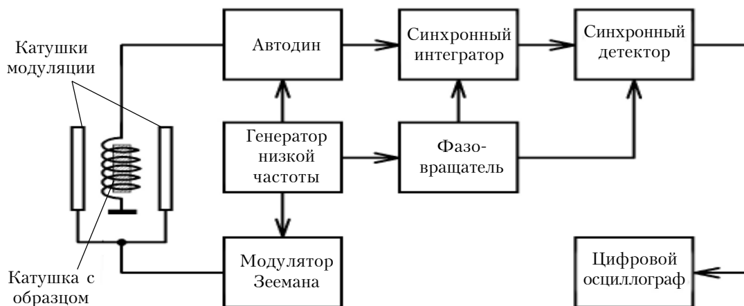
Рис. 1. Структурная схема спектрометра ЯКР с функцией частотного сканирования спектров
