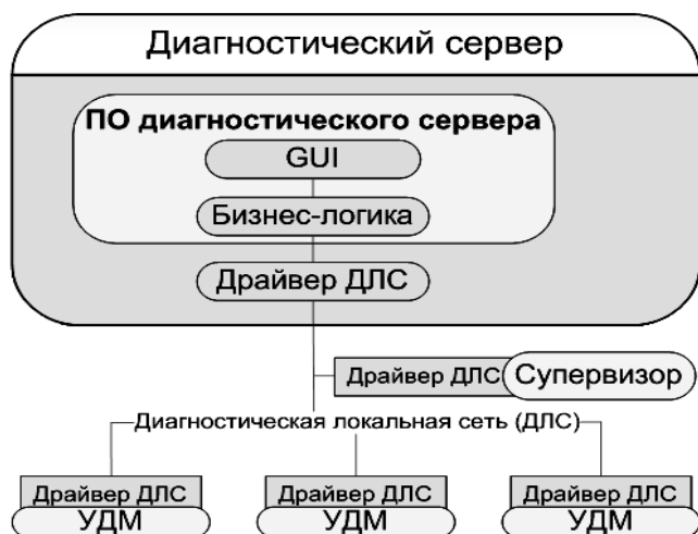
Рис. 2. Структурная схема системы диагностики для установок электронно-лучевой сварки
