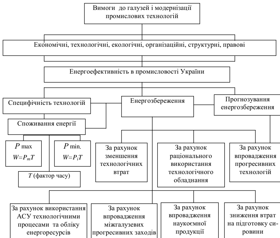
Рис. 2. Блок-схема структури енергоефективності в промисловості
