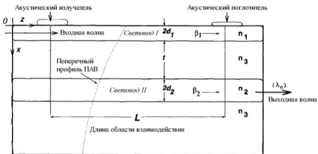
Рис. 5. AOTF на основе оптического двухволноводного направленного ответвителя [30]
