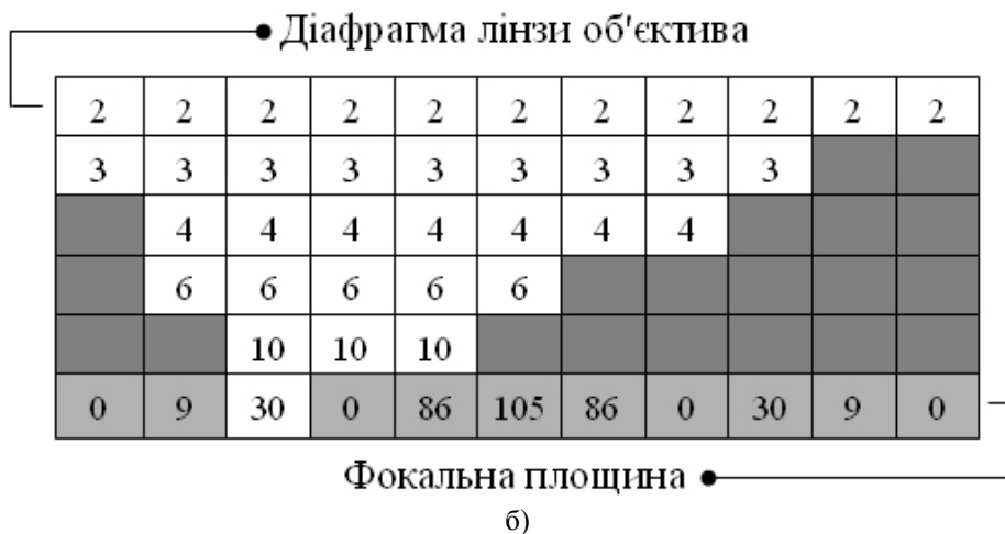
Рис. 2. Побудова двовимірних матриць, що є складовими вертикального зрізу тривимірної функції розподілу інтенсивності сфокусованого світла: а) аналіз центральної точки інтерференційної картини; б) аналіз першого піку побічного максимуму
