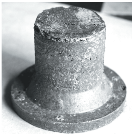
Рис. 1. Виливок деталі з піноалюмінію для гасіння вібрації та енергії удару
