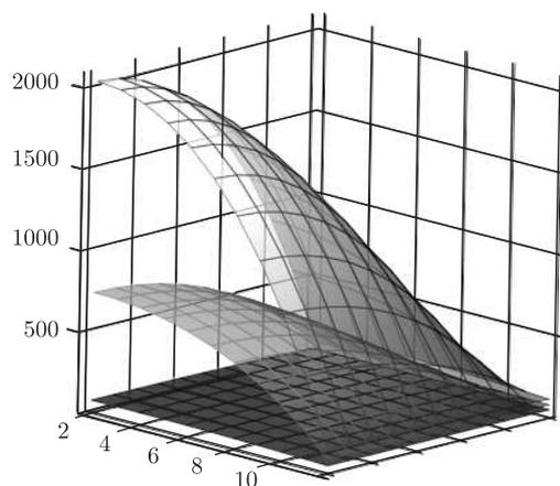
Рис. 4. Температура бесконечной прямоугольной призмы для  $0,001\text{Fo}$  (нижний график),  $0,01\text{Fo}$  (верхний график) и  $0,02\text{Fo}$  (средний график)
