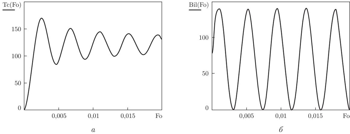
Рис. 3. Температура среды, осциллирующая как функция Бесселя (а) и критерий Био, осциллирующий по синусоиде (б)
