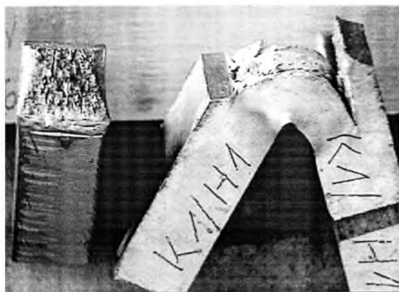
Рис. 1. Типові зломи випробувань на ударну в'язкість зразків Шарпі, вирізаних із верхньої (зліва) та нижньої (справа) частин експлуатованої труби.
