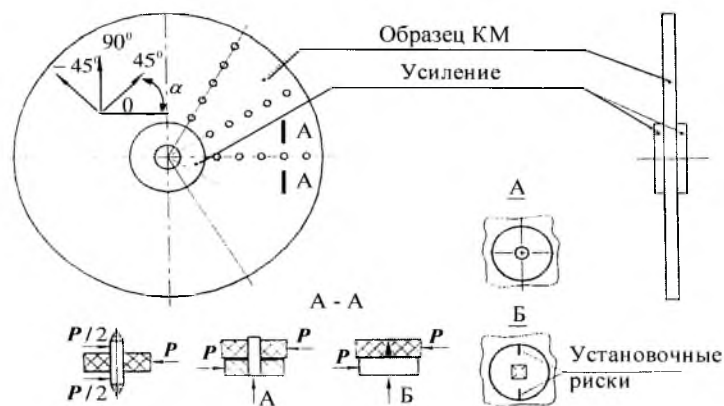
Рис. 5. Конструкция образца для исследования прочности КМ на смятие.
