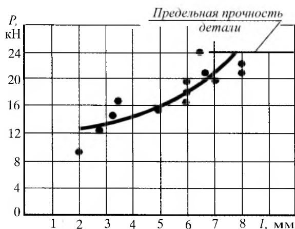
Рис. 3. Зависимость прочности соединения от длины зоны совмещения. (Сплошная линия – аппроксимация; точки – данные эксперимента.)
